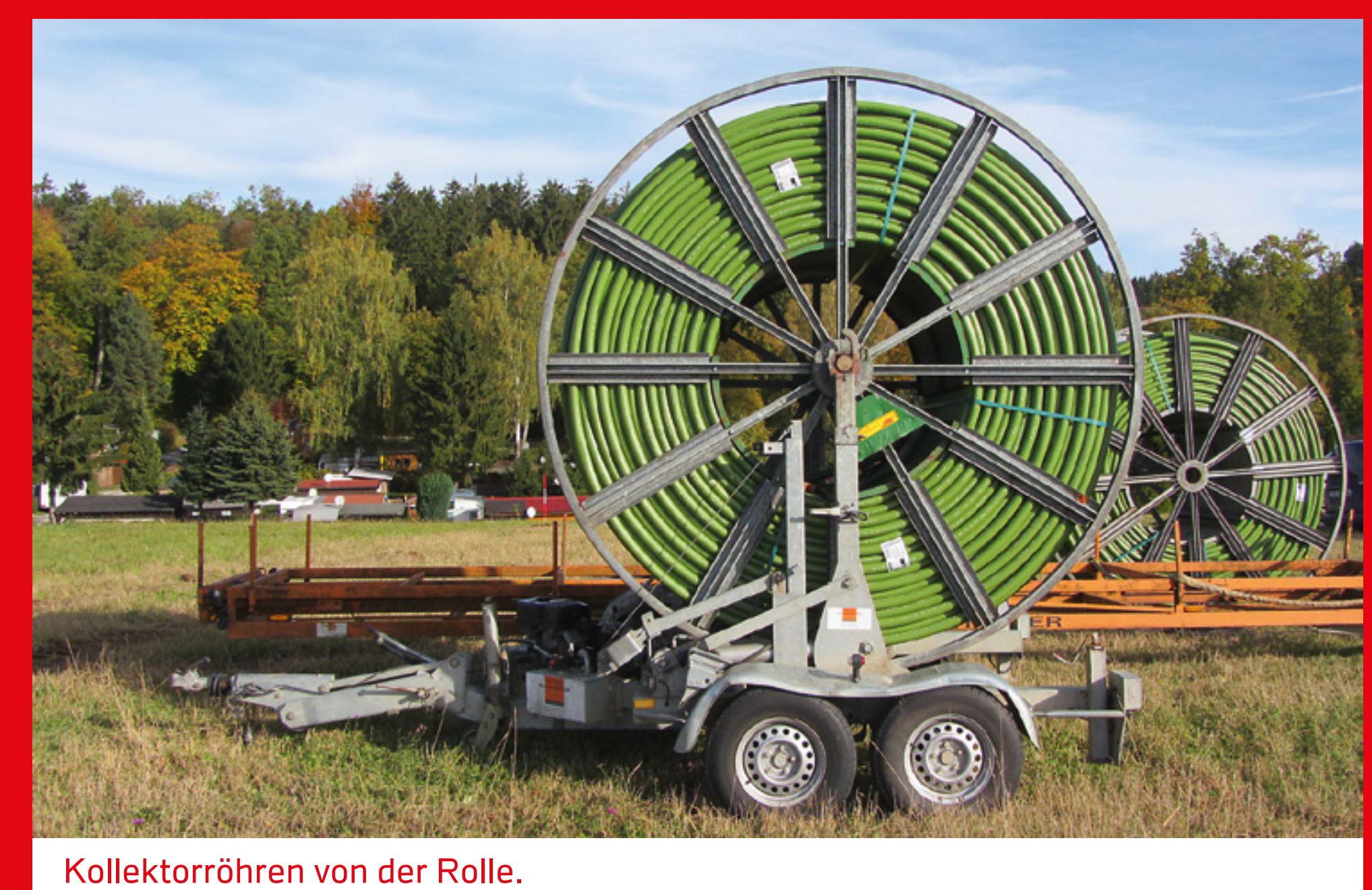
Kollektorröhren von der Rolle.
