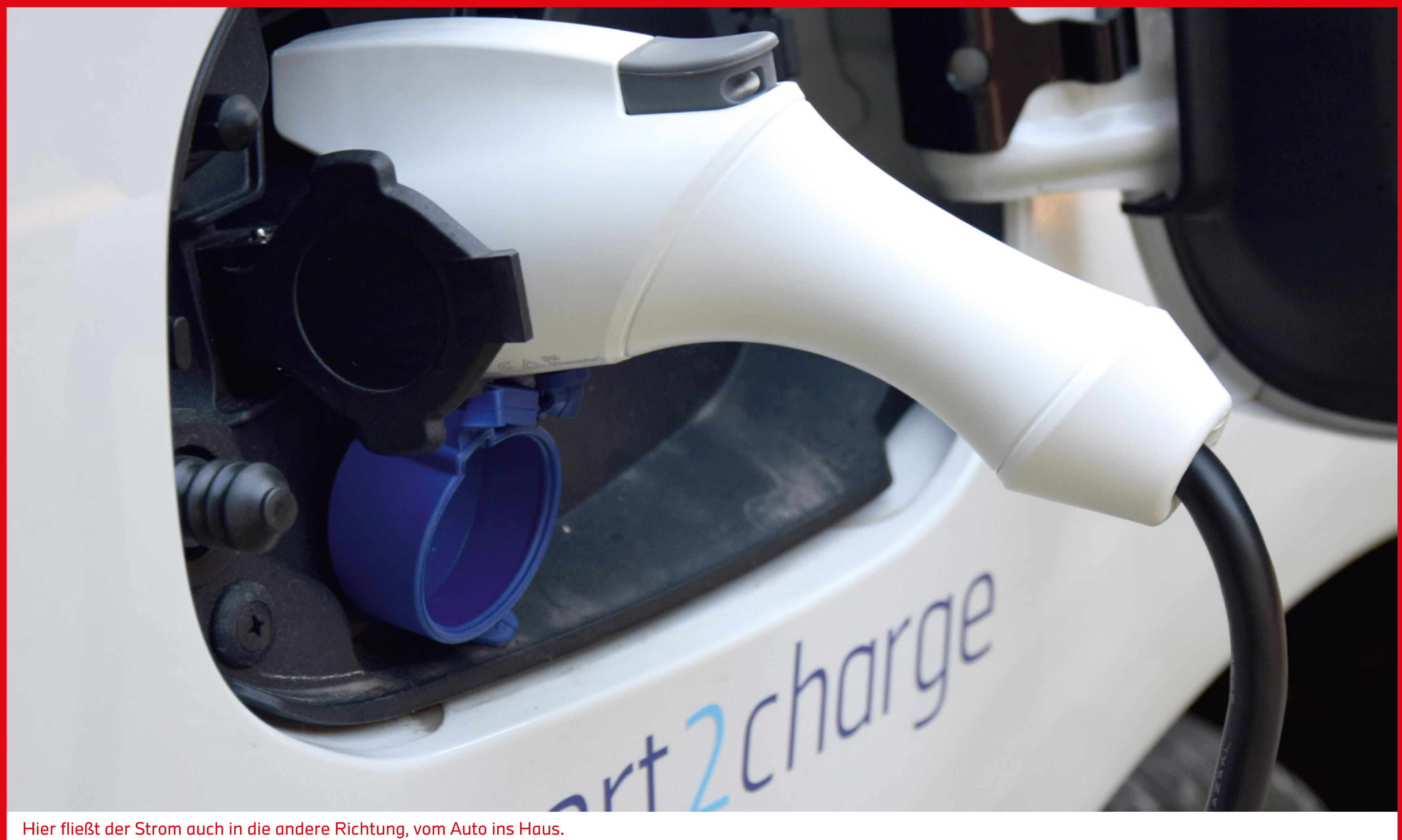
Hier fließt der Strom auch in die andere Richtung, vom Auto ins Haus.
